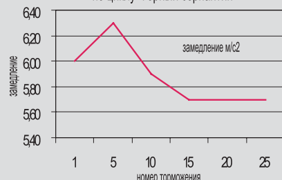
Результаты испытаний тормозных дисков ALLIED NIPPON по циклу "Горный серпантин"
